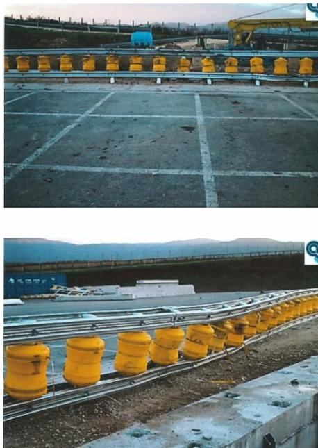
Figura 43: Barrera después del choque, por Crash Test Report # Mash 014– Centro Prove Aisico 2016
