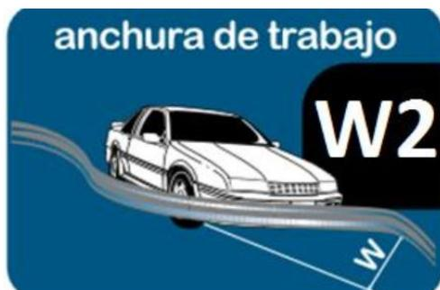
Figura 36: Anchura de trabajo resultante, por Informe industrial y comercial del Sistema de barrera para la seguridad vial – Barrera Tubular S.L
