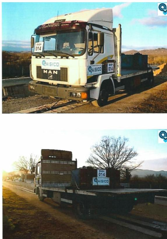
*Figura 41: Vehículo antes del choque, por Crash Test Report # Mash 014– Centro Prove Aisico 2016*
