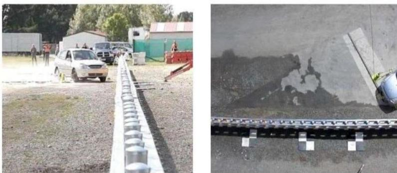
Figura 19: Vista de prueba de contención por “Presentación de estudio de caso sobre sistema de barrera rodante” por Academy of Engineering (2017)
