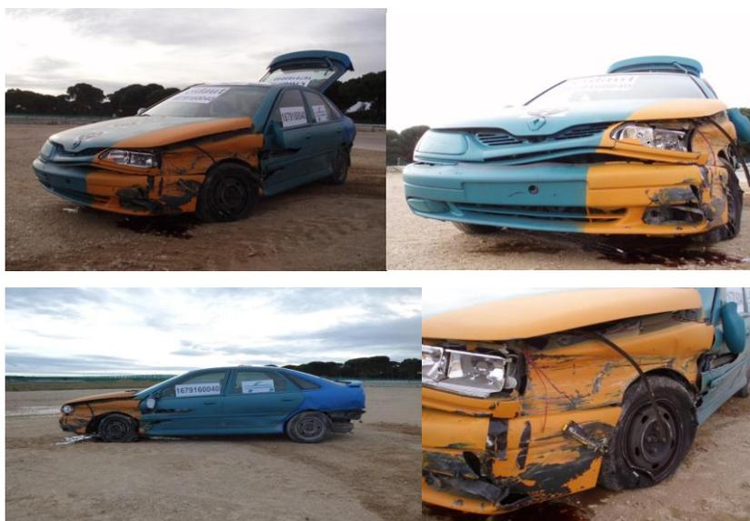
Figura 17: Vehículo posterior a la prueba, por Informe industrial y comercial del Sistema de barrera para la seguridad vial – Barrera Tubular S.L
