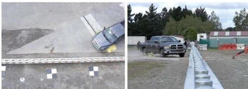
Figura 21: Prueba de contención con vehículo Pick Up, por “Presentación de estudio de caso sobre sistema de barrera rodante” por Academy of Engineering (2017)
