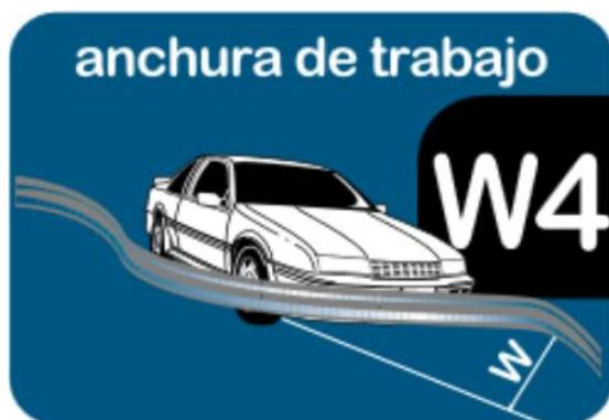
Figura 35: Anchura de trabajo resultante, por Informe industrial y comercial del Sistema de barrera para la seguridad vial – Barrera Tubular S.L
