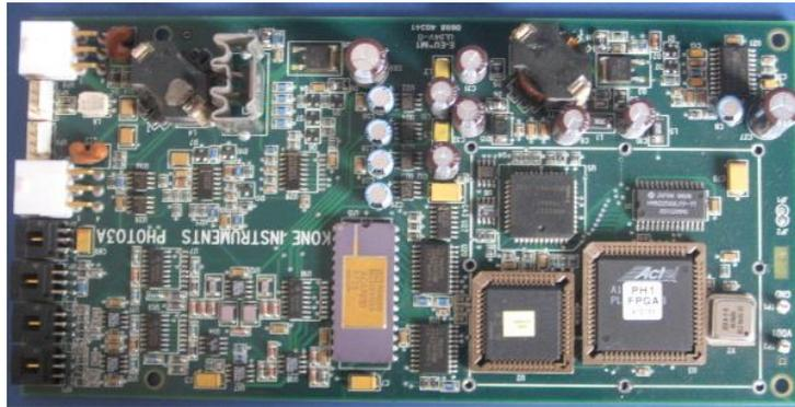
Figura 2.9: Amplificación, AD y FPGA controladora.
