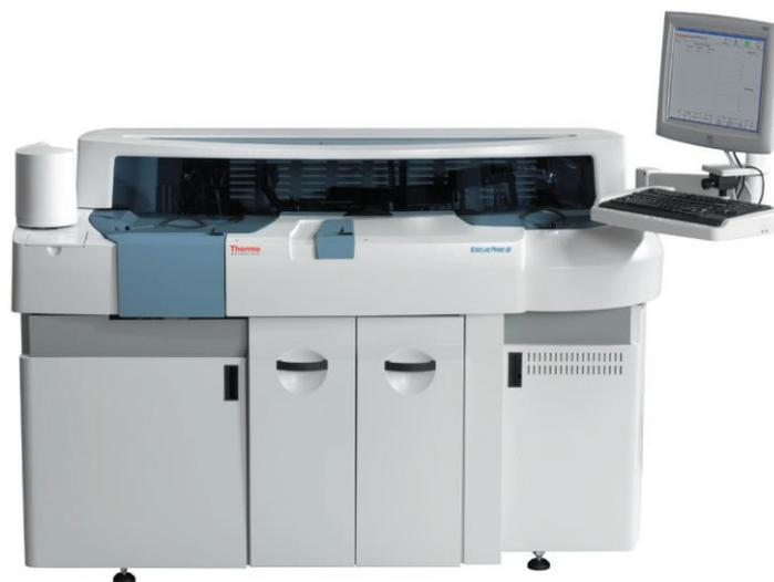
Figura 2.6: Equipo Automatizado Konelab Prime<sup>12</sup>
