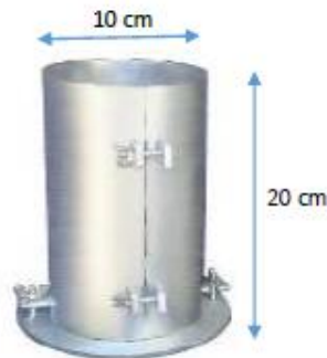
Figura 11: Molde para ensayar a compresión
