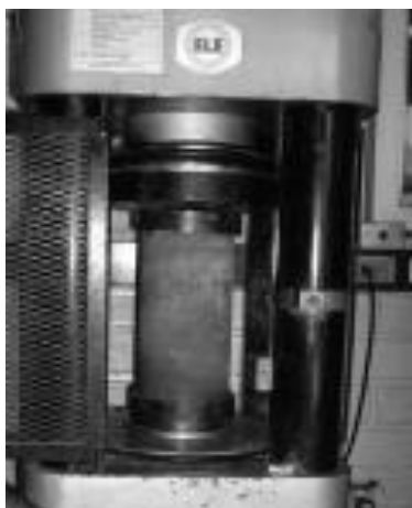
Figura 2: Ensayo a compresión axial de un cilindro de hormigón.
