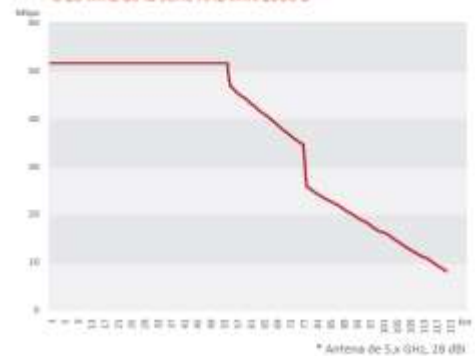
Rendimiento total de ancho de banda a 20 MHz de la serie RADWIN 2000 B
