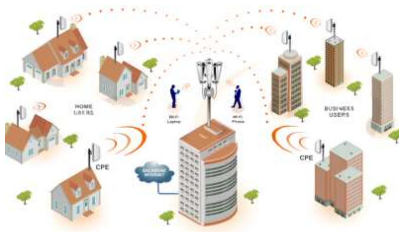
Figura 8: Esquema de un Enlace Punto Multipunto (PMTP)
