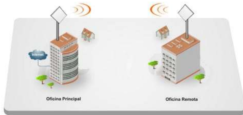
Figura 7: Esquema de un Enlace Punto a Punto (PTP)
