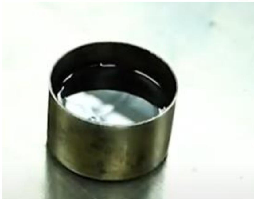
Figura N° 1: Muestra de cemento asfáltico en recipiente cilíndrico.
