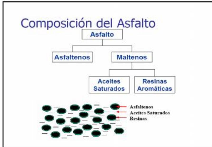
Figura N° 9: Composición química del asfalto
