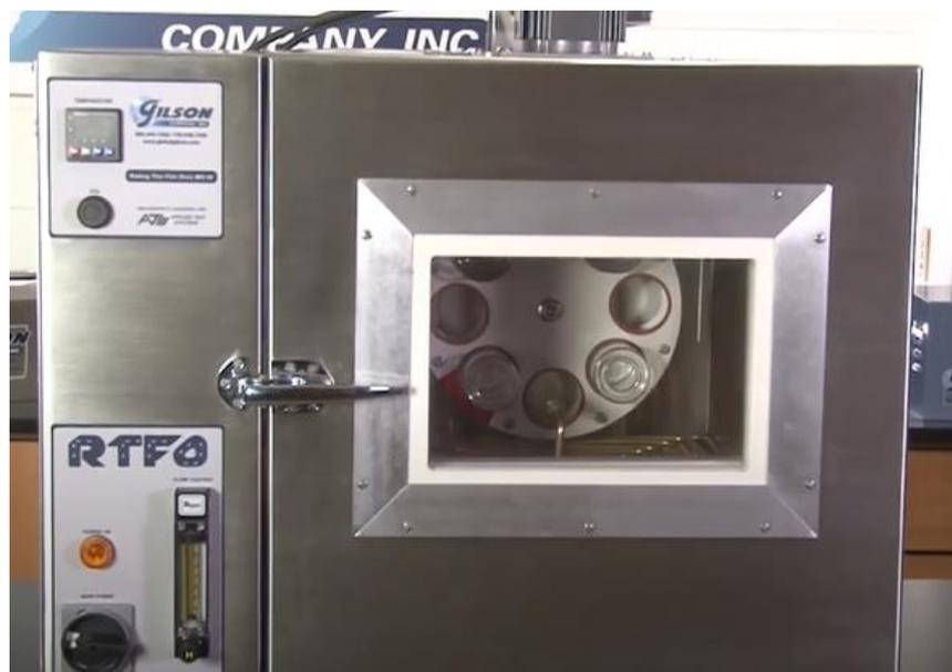
Figura N° 18: Horno Rotatorio de película delgada
