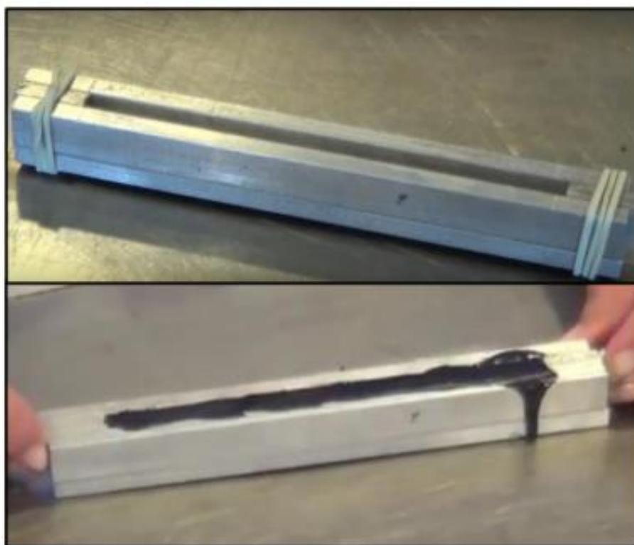
Figura N° 15: Molde de la viga.
