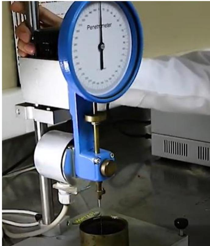
Figura N° 2: Ensayo de penetración.
