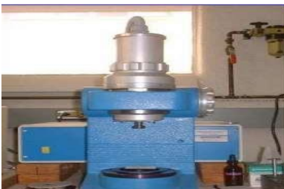
Figura N° 5: Reómetro Dinámico de Corte
