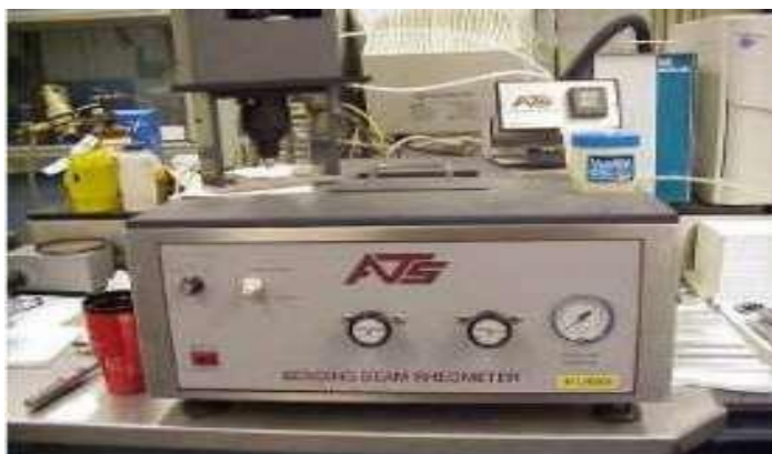
Figura N° 7: Reómetro de viga de flexión
