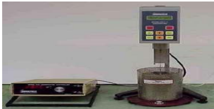
Figura N° 6: Viscosímetro cilíndrico rotacional coaxial Brookfield
