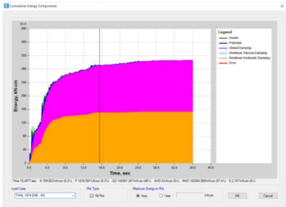
Figura 95. Disipación de energía por análisis THNL, sismo 1974 Ene. NS
