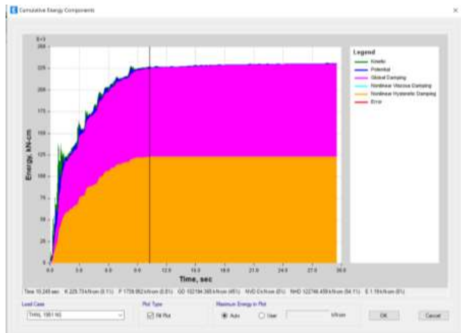
Figura 92. Disipación de energía por analisis THNL, sismo 1951 NS
