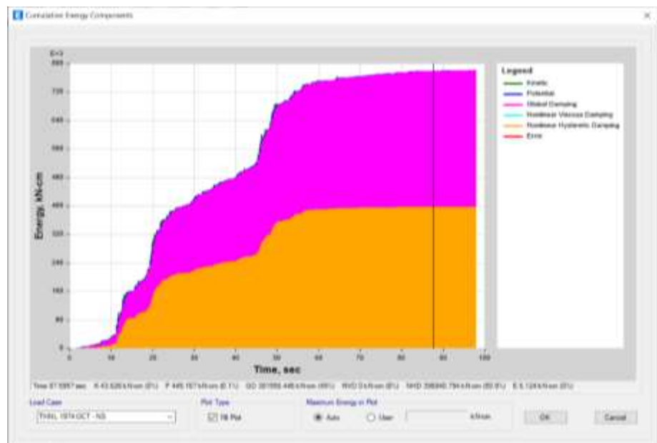
Figura 96. Disipación de energía por análisis THNL, sismo 1974 Oct. NS
