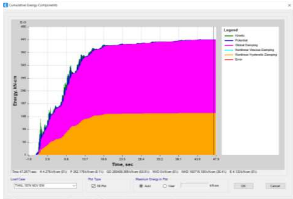
Figura 62: Disipación de energía por análisis THNL sismo 1974 Nov. EW
