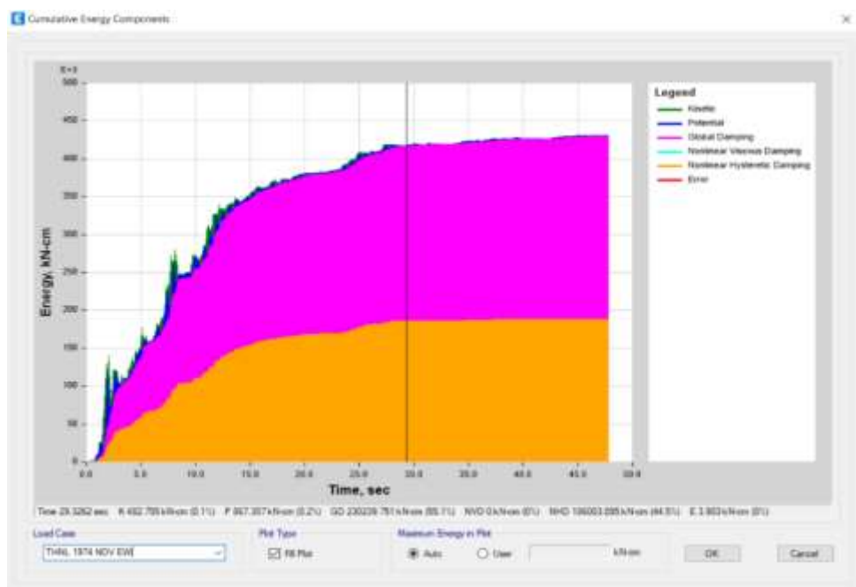
Figura 90. Disipación de energía por análisis THNL, sismo 1974 Nov. EW
