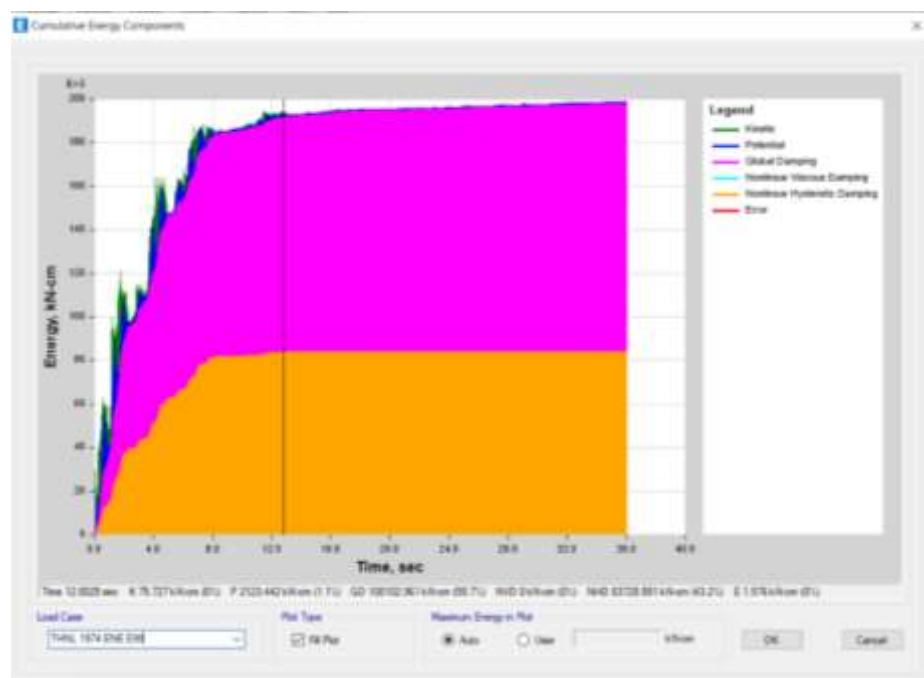
Figura 88. Disipación de energía por THNL, sismo 1974 Ene. EW
