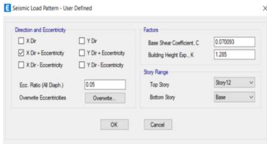
Figura 17: Incorporación de factores de carga de sismo en la dirección X
