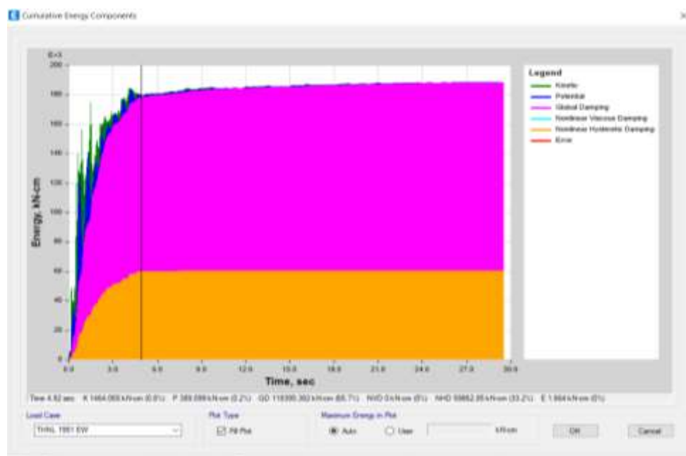
Figura 57: Disipación de energía por análisis THNL, sismo 1951 EW
