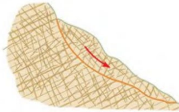
Figura N° 16: Esbozo de una falla en curva
