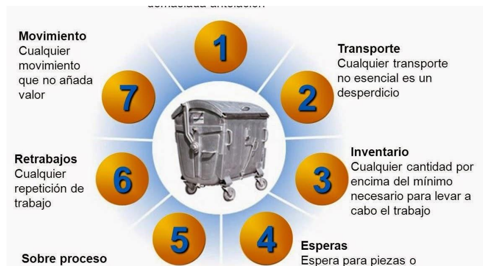
Figuran 1 Desperdicios en la construcción
