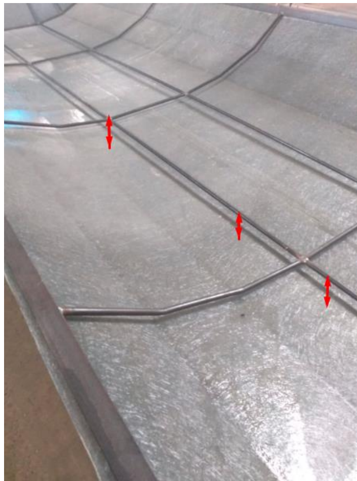
Figura 26. Espaciado entre estructura y carcasa de fibra
