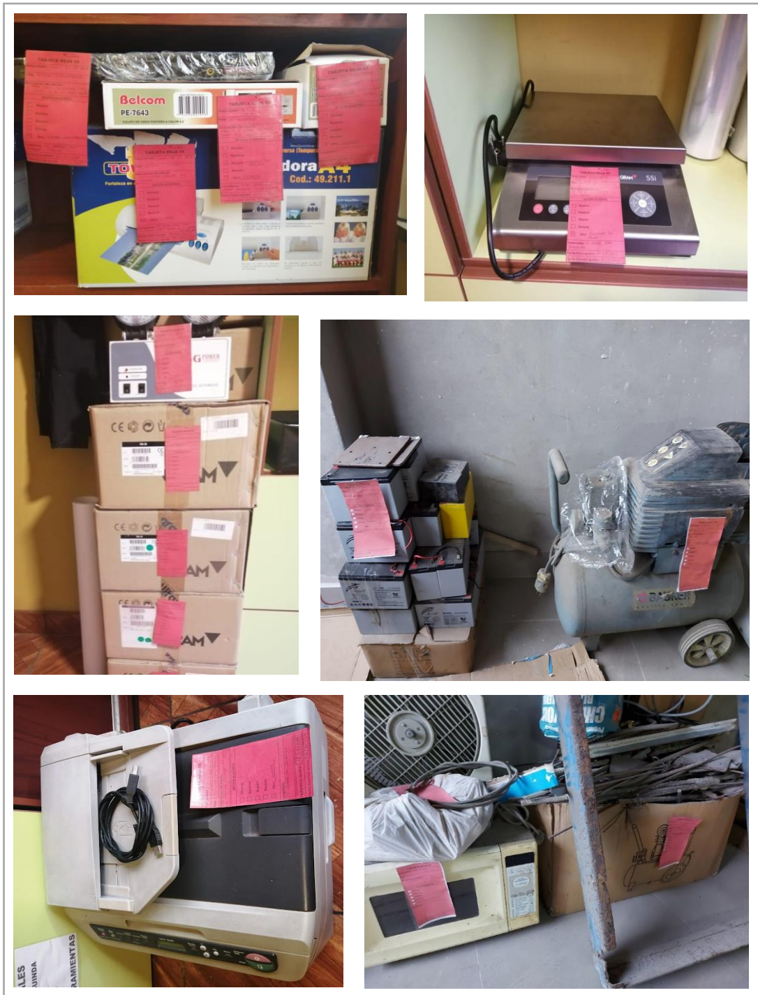
Figura 42: Fotografías sobre el uso de tarjetas rojas en el taller y oficina de mantenimiento
