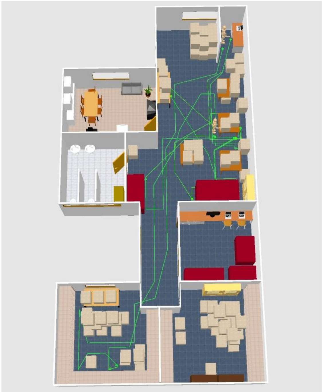
Figura N° 14: Distribución Actual de la Planta con recorridos en software Sweet Home 3D – Vista 3D vertical Fuente: Elaboración Propia
