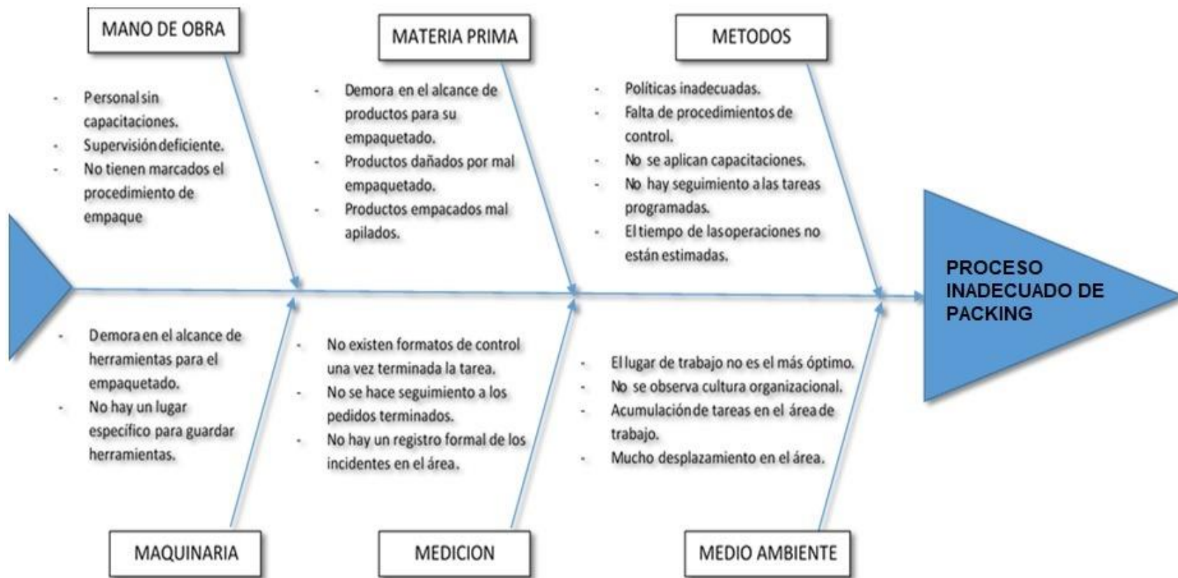
Figura N° 4: Diagrama Ishikawa del Proceso de Packing actual Fuente: Elaboración Propia
