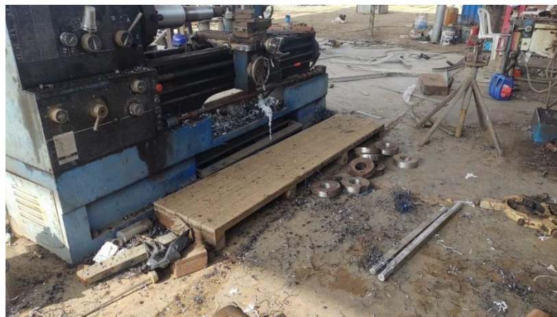
Figura N° 15: Falta de limpieza, objetos y virutas en suelo. Fuente: Elaboración propia.
