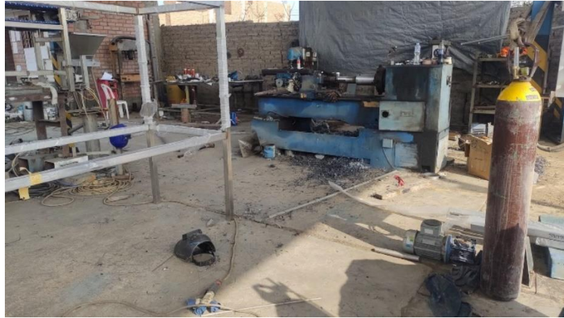
Figura N° 14: Deficiente distribución de maquinaria y objetos Fuente: Elaboración propia
