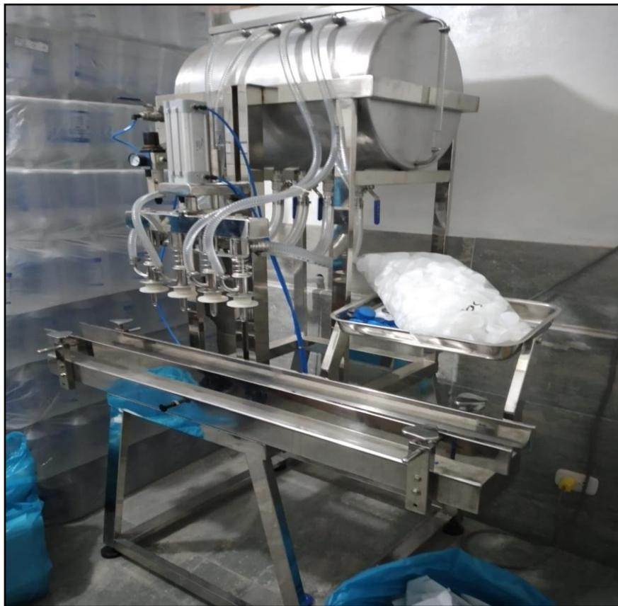
Figura N° 23: Máquina embotelladora.
