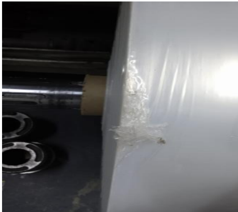
Figura 18: Bobina dañada Fuente: Elaboración propia.
