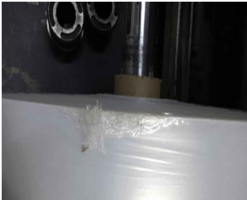
Figura 38: Daños en la bobina. Fuente: Elaboración propia
