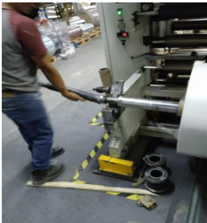
Figura 36: Montaje de bobina lado izquierdo. Fuente: Elaboración propia
