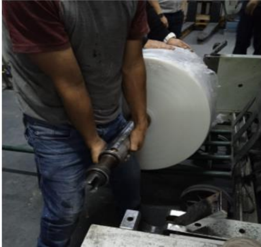
Figura 37: Montaje de bobina lado derecho. Fuente: Elaboración propia
