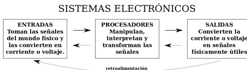
Figura N°10: Sistema electrónico
