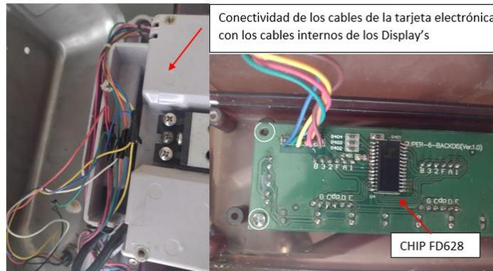
Figura N°55: Conectividad de la tarjeta electrónica SUPERSS
