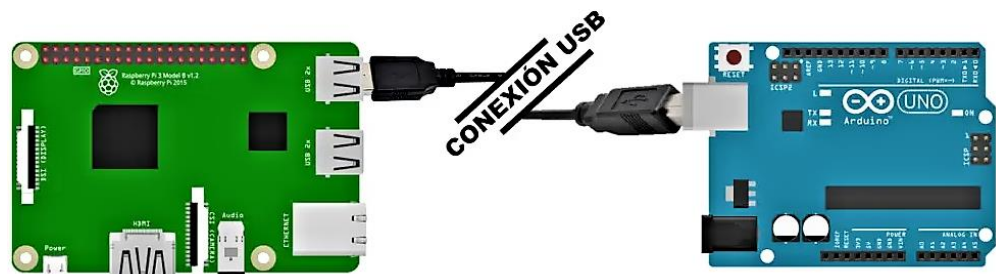
Figura 41: Conexión USB entre Etapas lógicas: Raspberry Pi – Arduino Fuente: Cytron. (2021)
