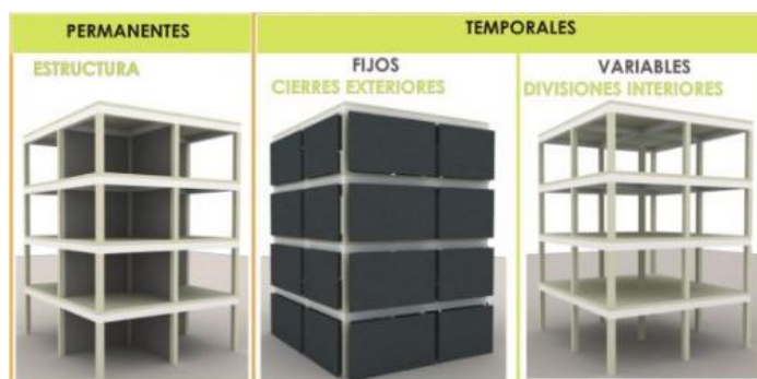
Figura 4: Clasificación de elementos en una edificación progresiva
