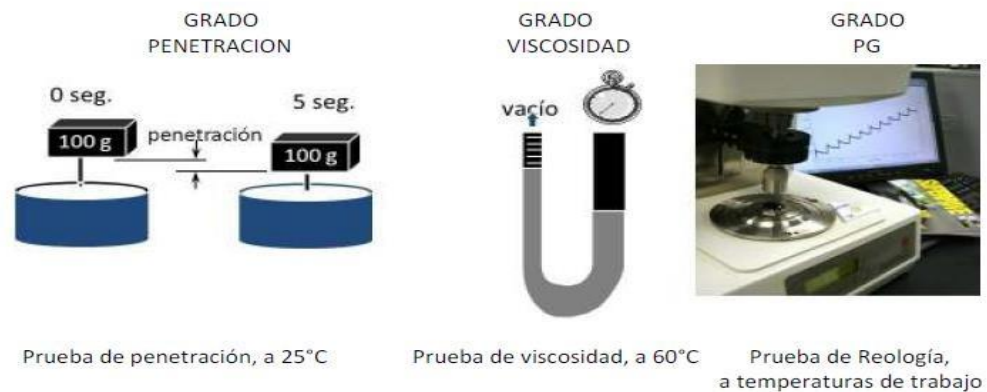
Figura N° 1: Clasificación de cemento asfáltico en el Perú
