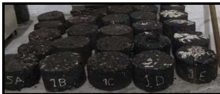
Figura N° 6: Briquetas de Mezcla Asfáltica Convencional
