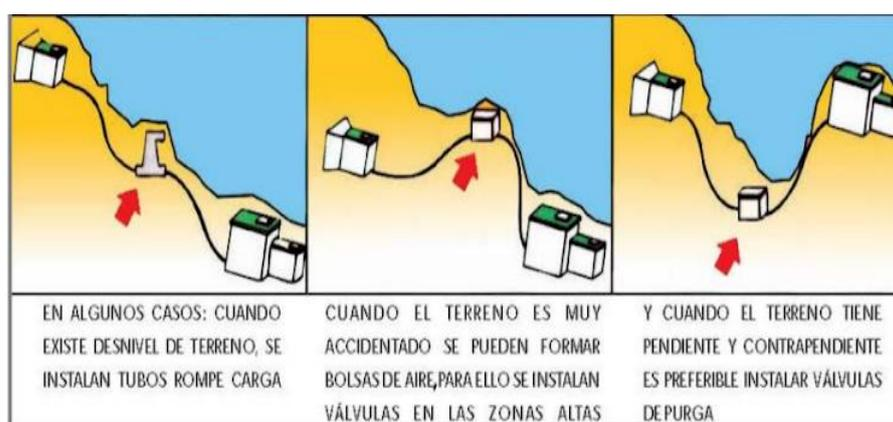
Figura N° 14: Línea de Conducción
