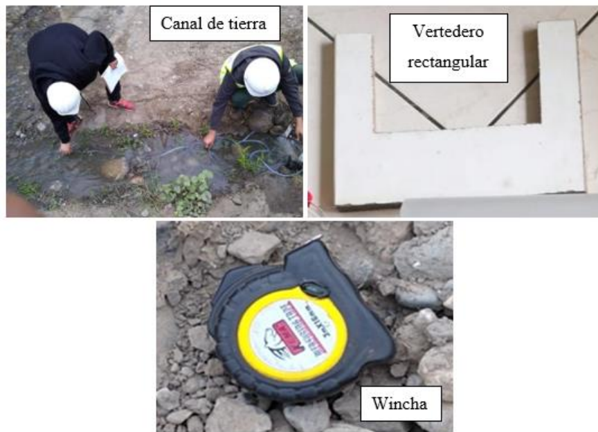
Figura 72. Instrumentos utilizados para el aforo por vertedero Fuente: Elaboración Propia
