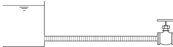
Figura 39. Toda la tubería en depresión
