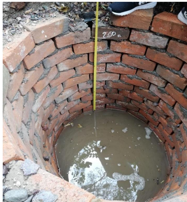
Figura N° 24: Prueba de permeabilidad.
