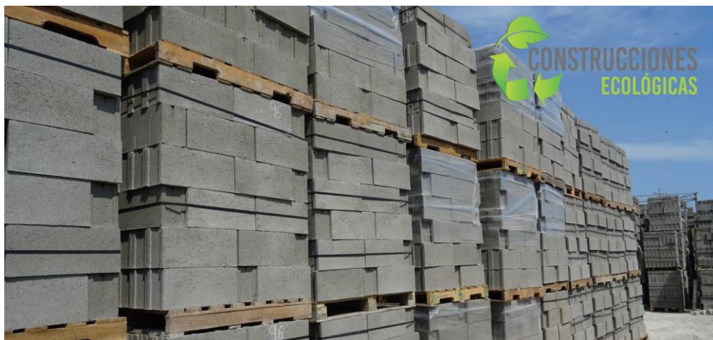
Figura 59 Bloques de concreto a partir del reciclaje de las RCD
