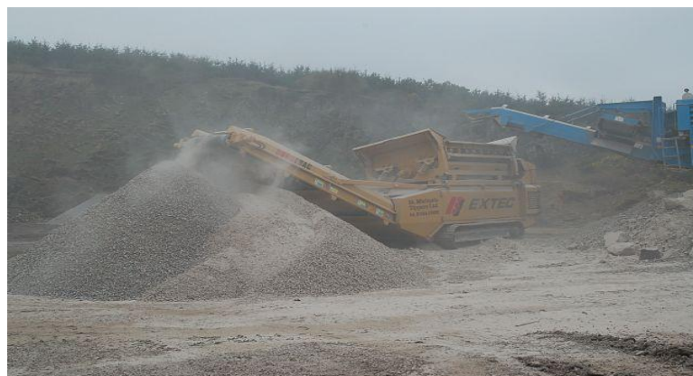
Figura 39 Generación de agregado reciclado
