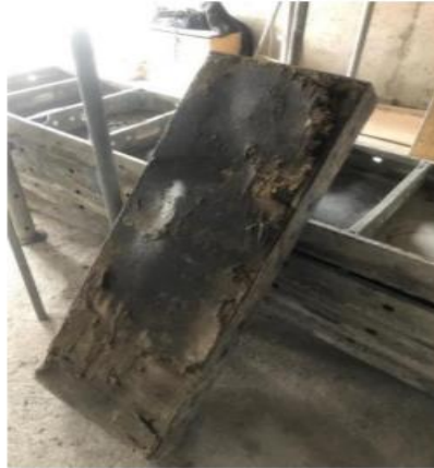
Figura 27 Placa fenólica descartada por mal estado
