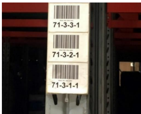
Figura 21: Codificación de racks.
