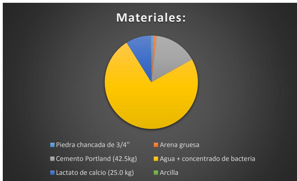
Figura N° 71: Costo de elaboración 1m 3 de concreto más concentrado de bacteria y lactato de calcio f'c=210kg/cm 2 costo total: 1375.04 soles.
