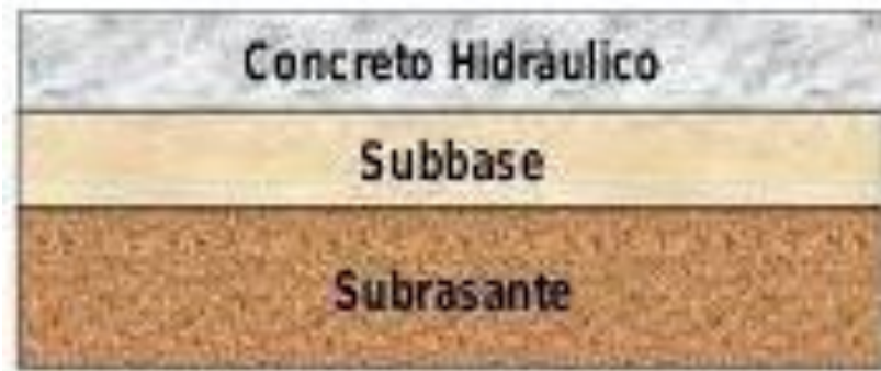
Figura N° 12: Sección transversal de pavimento hidráulico.
