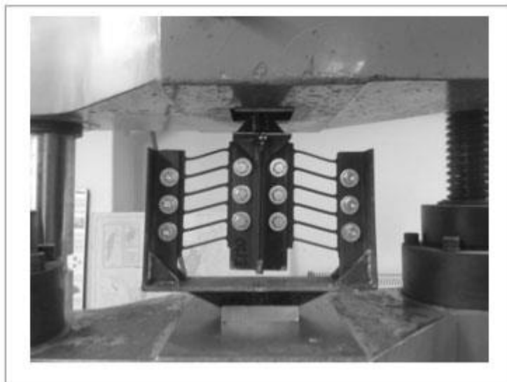
Figura N° 8 Montaje del ensayo de caracterización mecánica del disipador con placas ranuradas.
