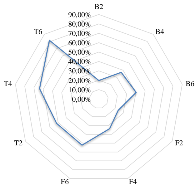
Figura 31: Variación porcentual de la resistencia a la flexión con respecto al concreto patrón de las mezclas con dosificaciones de fibras de poliolefina (3 tipos de formas: barchip (B), fibrilar (F) y retorcido (T)).
