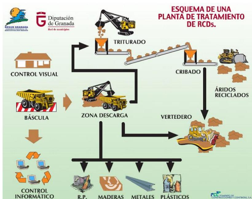
Figura 13. Esquema de una Planta de Tratamiento de RCDs.
