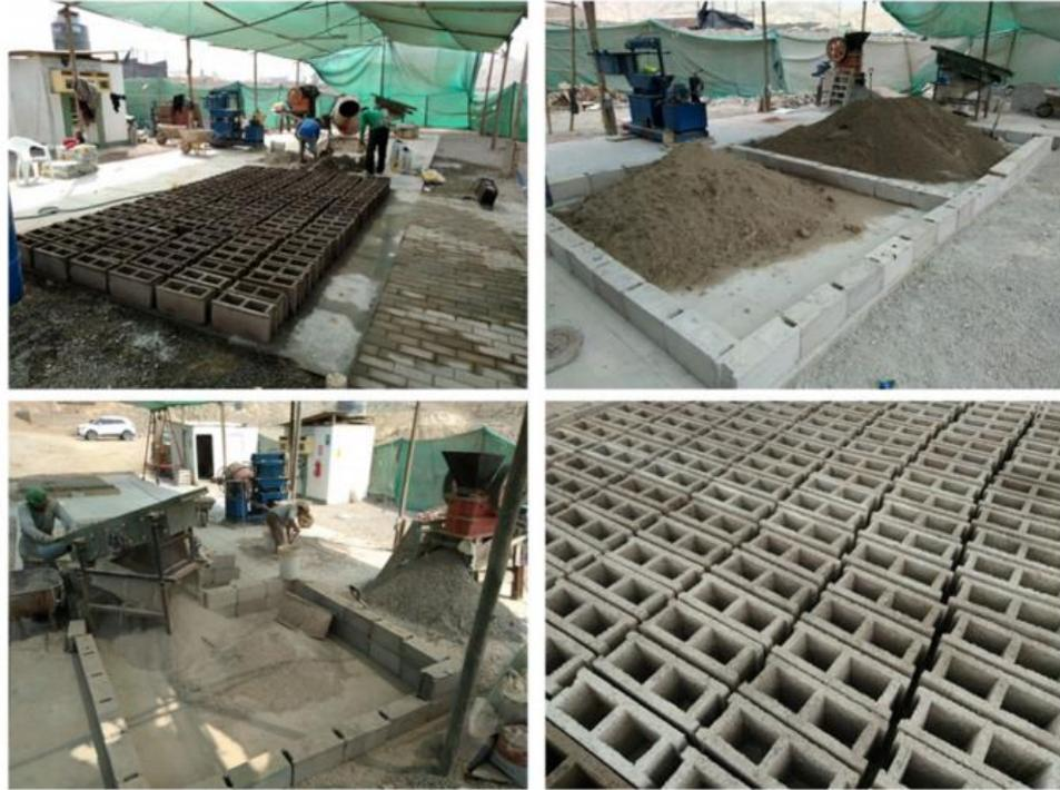
Figura 8. Fabricación de productos de construcción reciclados en la planta piloto, Cieneguilla, Lima.
