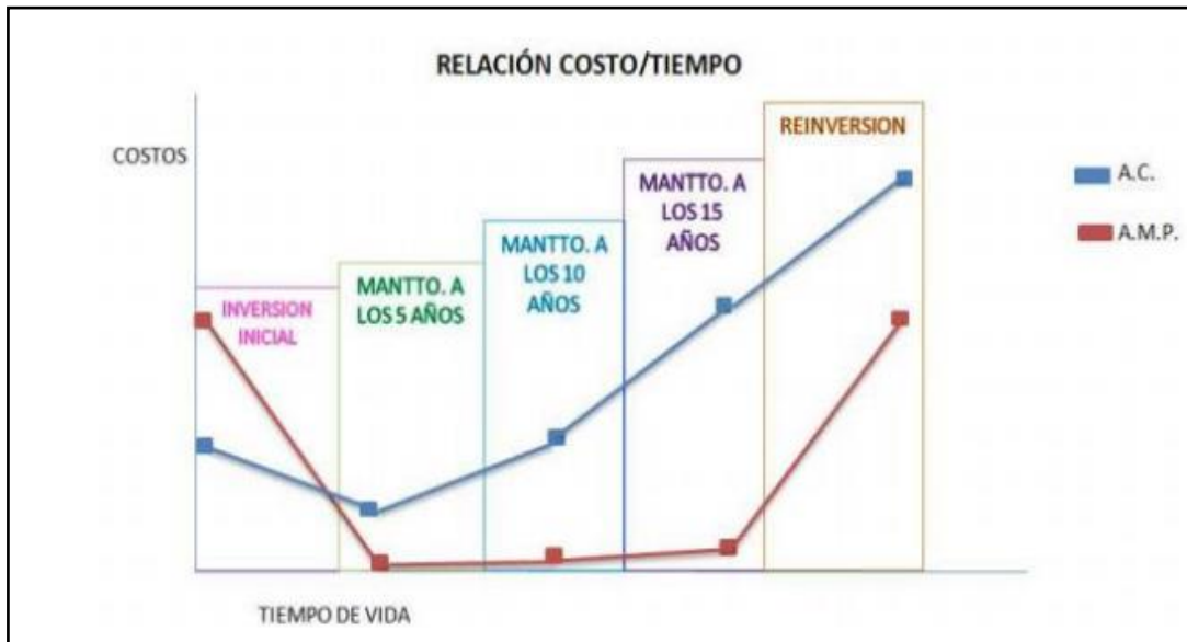
Figura N°18: Comparación a nivel de costos entre la mezcla asfáltica convencional y la modificada Fuente: Silvestre (2017)
