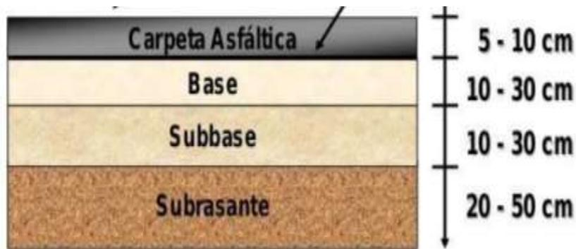
Figura 3: Estructura del pavimento flexible
