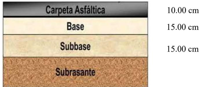
Figura 27: Espesores del pavimento estabilizado con concreto reciclado
