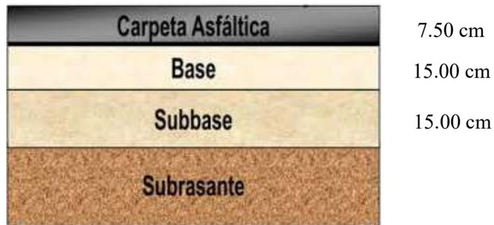
Figura 26: Espesores del pavimento estabilizado con concreto reciclado
