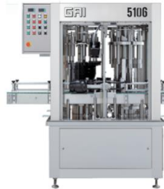
Figura 10: Lavadora secadora GAI5106, por GAI-Macchine Imbottigliatrici
