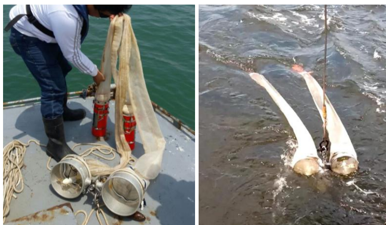
Figura 4. Red Baby Bongo de 22 cm de diámetro de boca equipada con dos vasos colectores.
