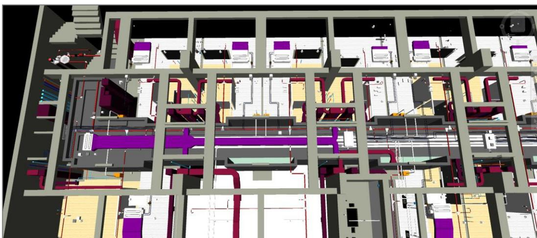
Figura N° 40: Vista del modelo 3D de las instalaciones en el pasillo del Hotel Intercontinental con el software Navisworks.
