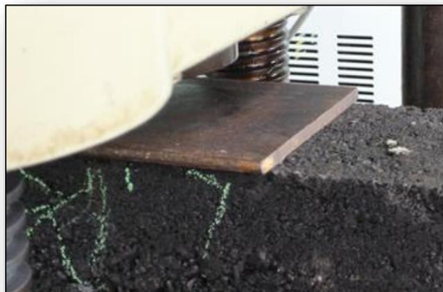
Figura 4.19. Se muestra la grieta principal en dirección vertical que nace de la grieta generada, además de otras.
