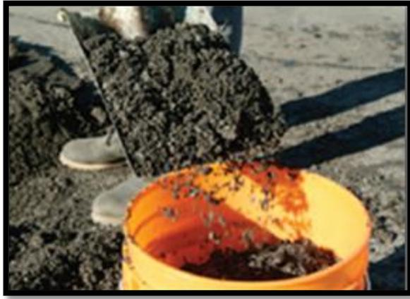
Figura 3.3. El asfalto molido que contiene el producto GlasGrid se puede reciclar fácilmente para usarlo en otros proyectos. (T.I.C., 2008)
