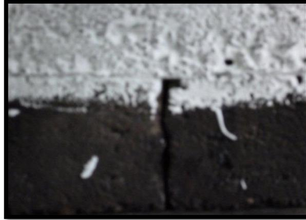
Figura 4.25. Se aprecia una línea horizontal encima de la grieta generada, es la geogrilla de fibra de vidrio.
