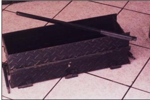
Figura 4.2. Imagen del molde con los arriostres y bisagras.
