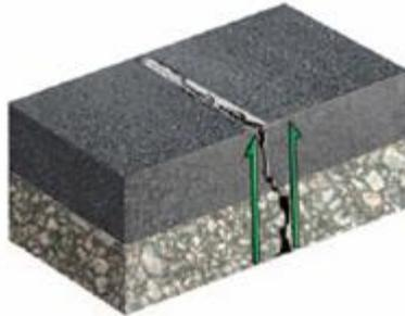
Figura 3.18. Reflexión de grietas hacia la superficie (T.I.C., 2008)
