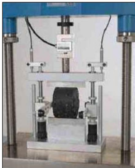
Figura 2.15. Prueba de fatiga por compresión (I.M.T., 2002).
