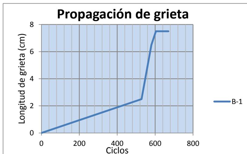
Figura 4.59. Longitud de grieta vs. n.º de ciclos (B-1).
