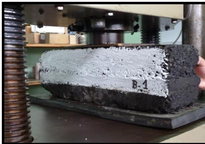
Figura 4.22. Viga B-1 desgastada después de un determinado número de ciclos.
