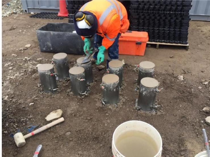
Figura 20. Elaboración de probetas
