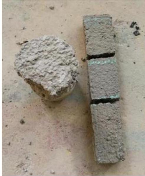
Figura 26. Ensayos a la compresión de concreto.
