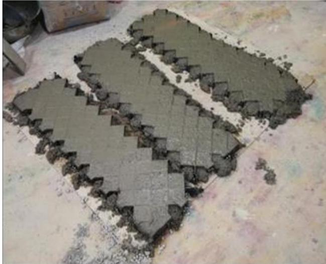
Figura 28. Compresión a la Flexión de Probetas de Concreto con Diamond Grid
