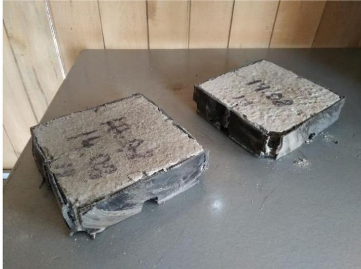
Figura 27. Compresión de Probetas de Concreto con Diamond Grid
