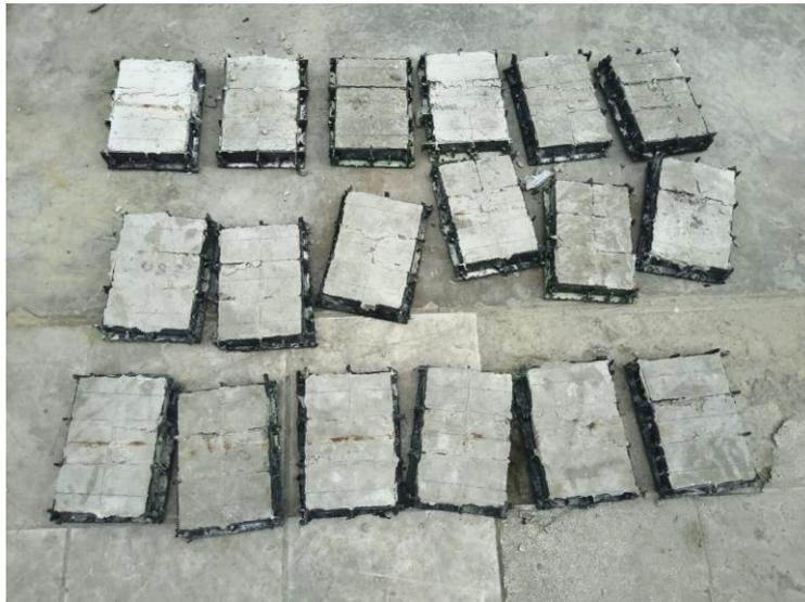
Figura 22. Probetas de Diamond Grid con concreto.
