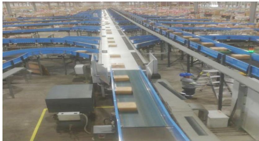
Figura N° 4: Sistema automático de clasificación de zapatas deslizantes Fuente: Elaboración propia
