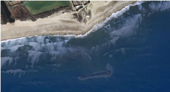
Figura 0.2. Difracción del oleaje frente un dique exento – Formación de Saliente. Fuente: Google Earth, 2012.
