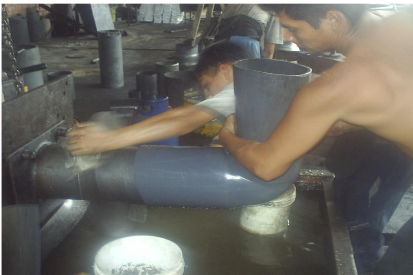
Imagen 5. Extracción de pieza colocada en matriz.
