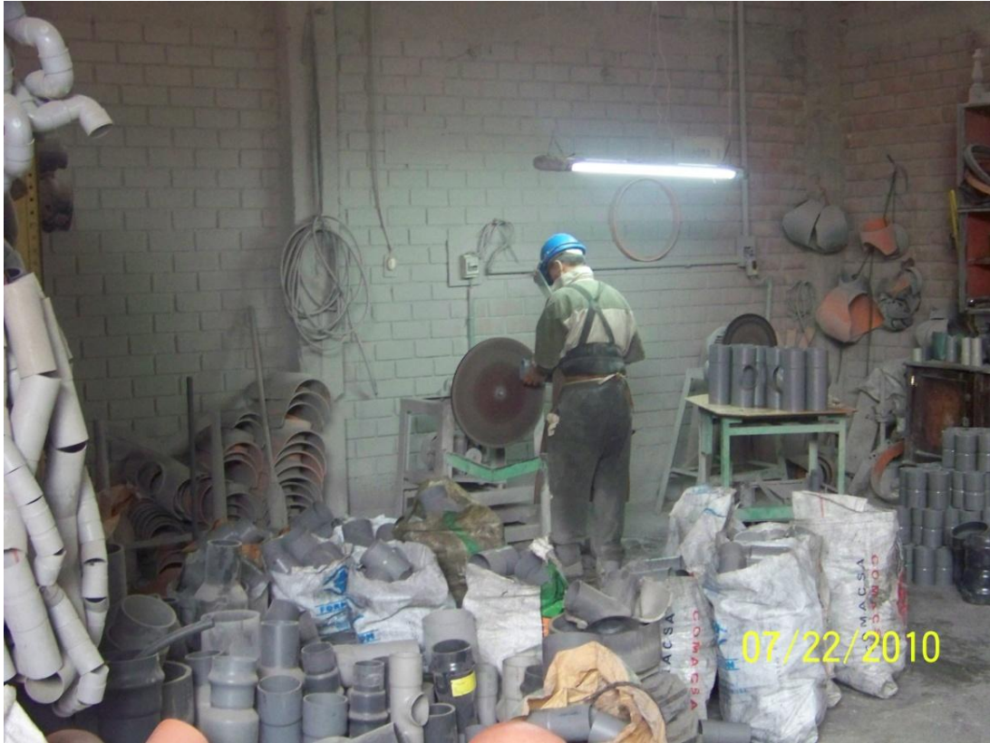
Imagen 8. Pulido y acabado final de pieza (codo) doblada a 90°.
