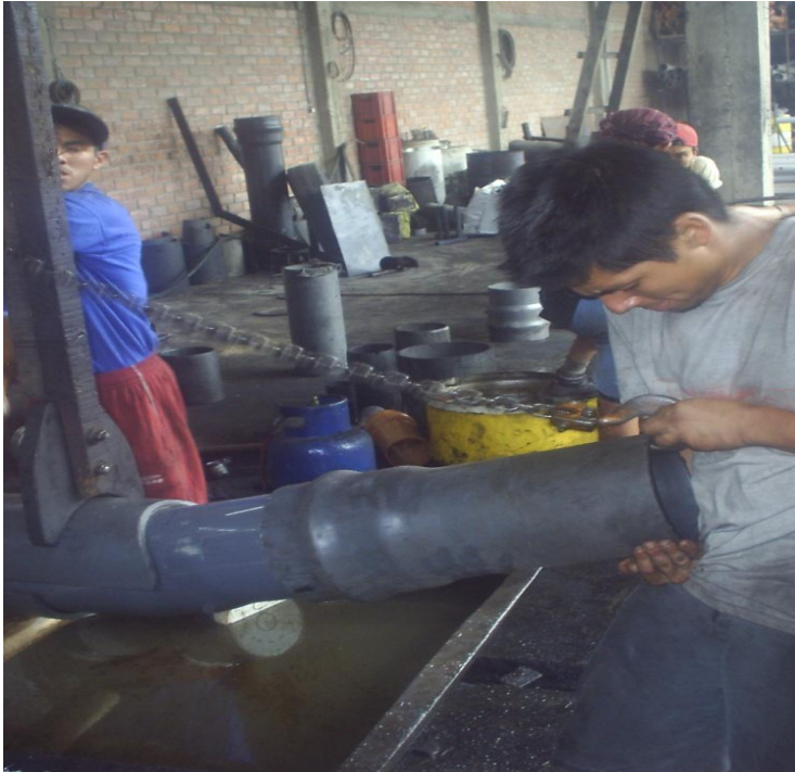
Imagen 4. Ubicación de cadena de arrastre antes de doblar pieza.
