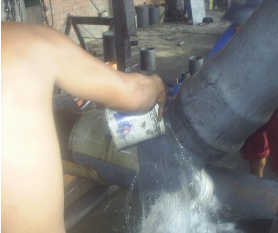
Imagen 7. Enfriamiento de pieza doblada a 45°.
