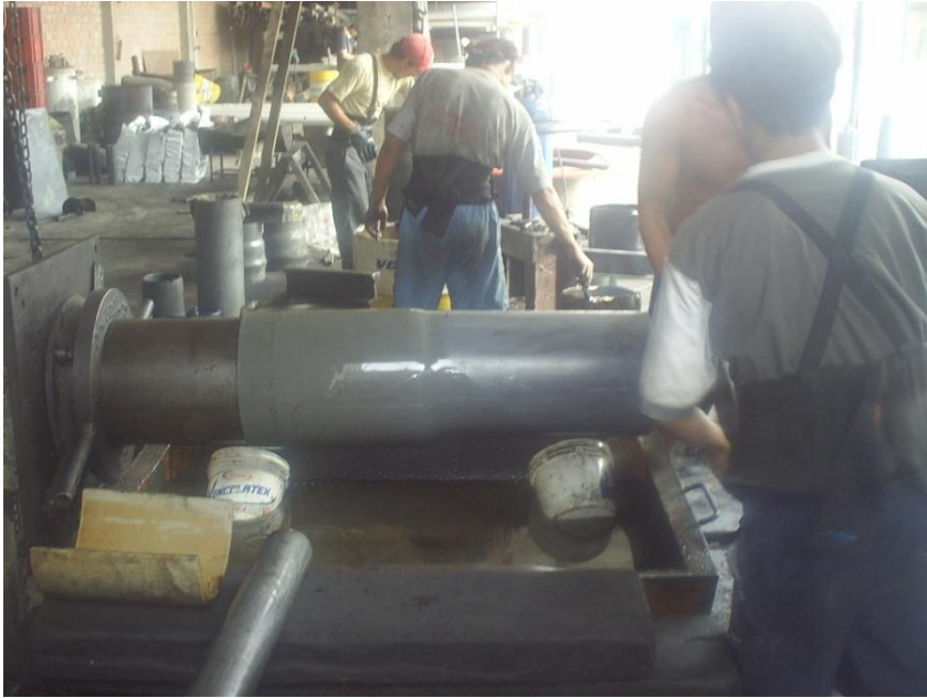
Imagen 3. Pieza antes de doblar a 45° colocada en matriz.
