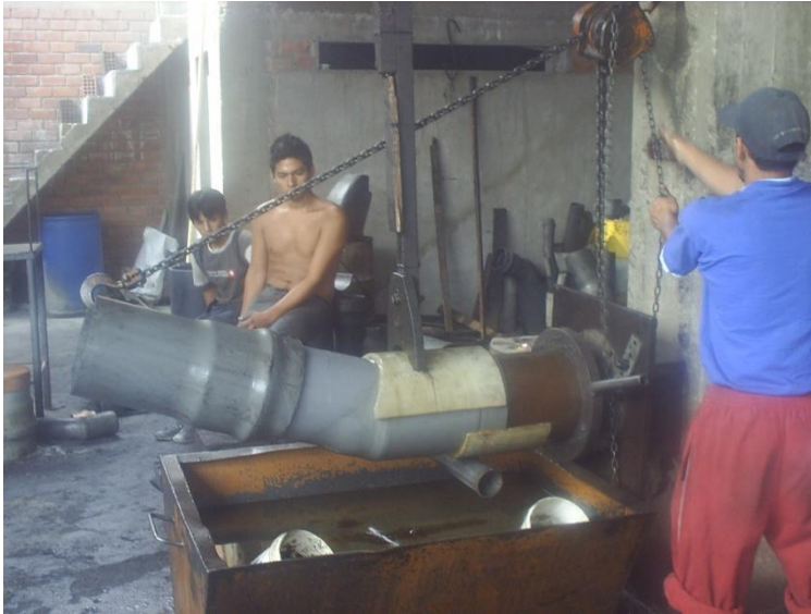
Imagen 6. Pieza doblándose a 45^\circ .
