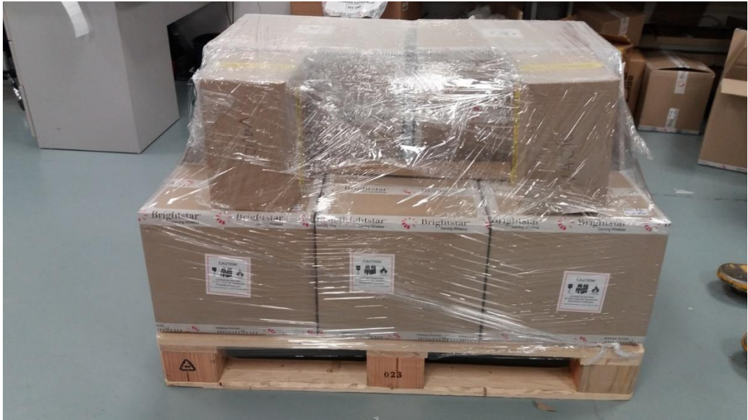
Figura 14. Pallet o skid de exportación con medidas 120x80x80 con 151 kg|
