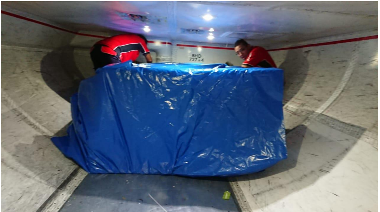
Figura 52. Proceso de protección con plástico de los espárragos dentro de la bodega del avión B737-800
