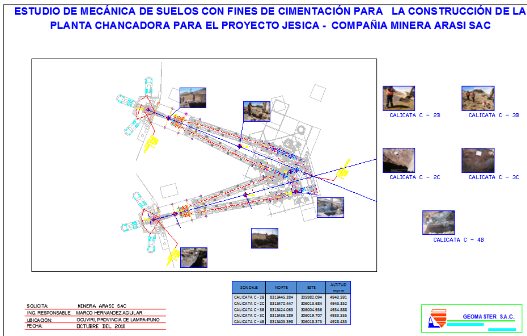
Imagen N°15: Plano de puntos de excavación para calicatas.
