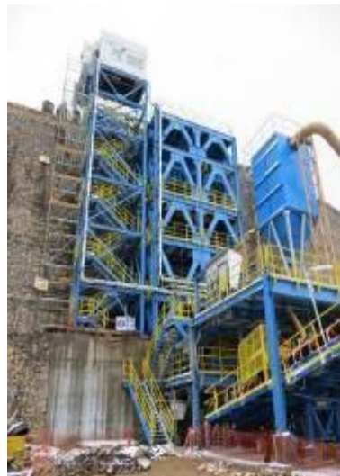
Colector de polvo en CHP, terminado y probado. OK
