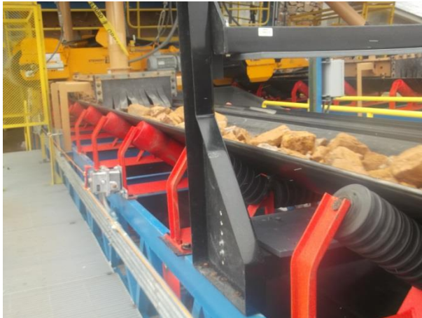
Faja CV-03: Prueba con carga
