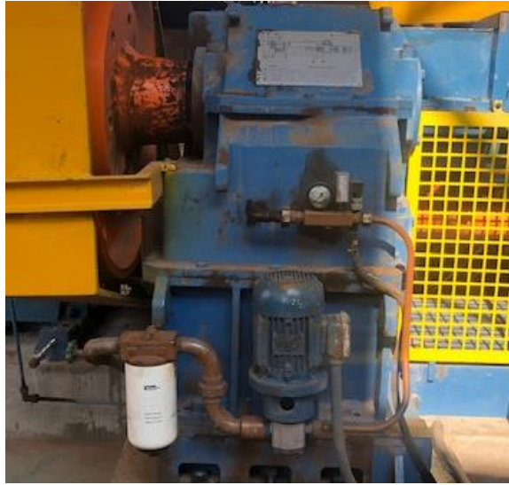
Figura N° 26 Sistema Hidráulico Caja de Reducción
