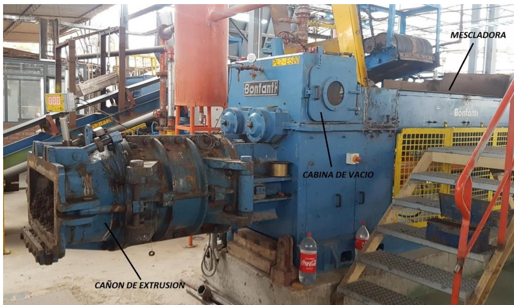
Figura N° 20 Vista lateral de Extrusora Señalando sus Partes Mecánicas
