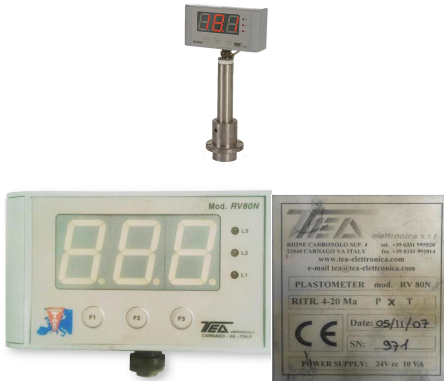
Figura N° 35 Plastometro Sensor de Temperatura y Presión
