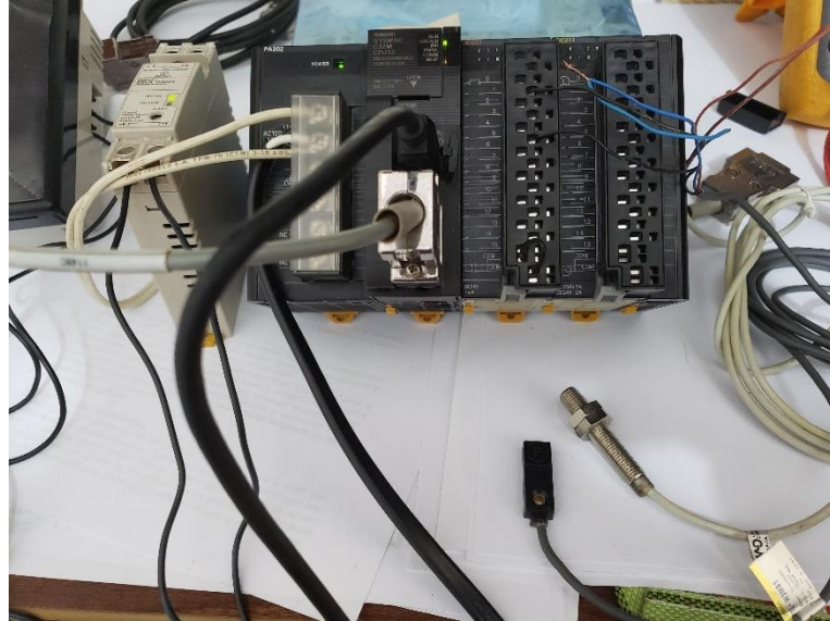
Figura N° 70 Conexión de dispositivos de entrada
