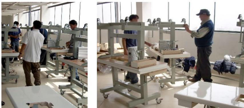
*Figura 27:* Procesos de ensamblaje de muebles para las máquinas de costura
