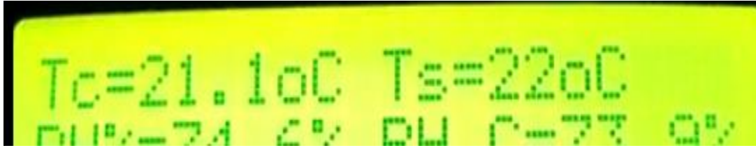
Figura 43: Visualización de la temperatura en la pantalla LCD
