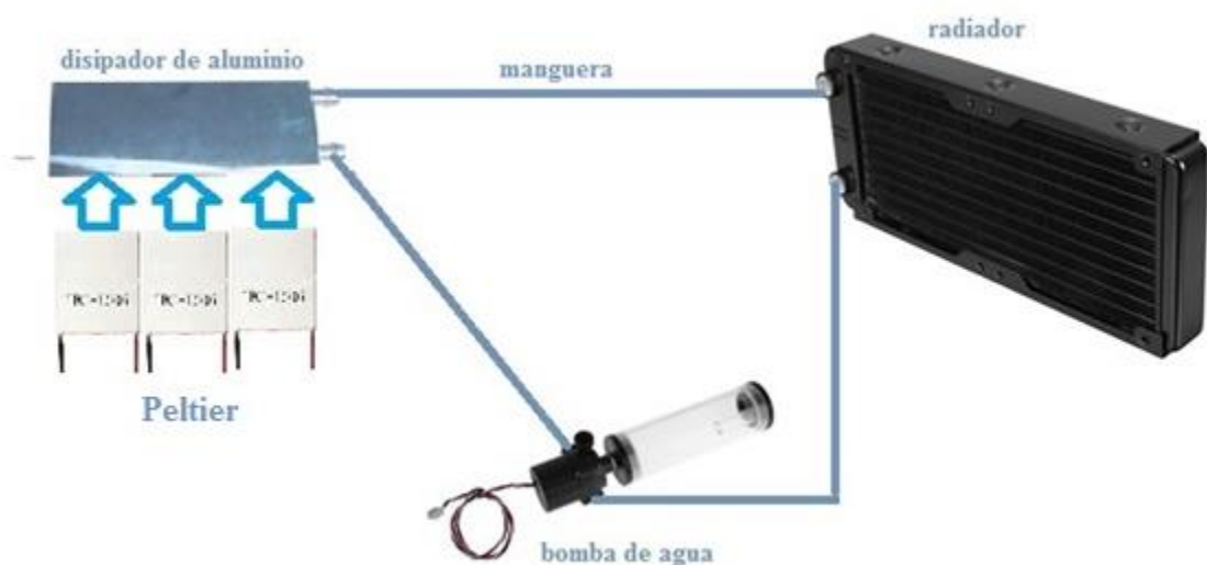
Figura 39: Conexión del disipador del Peltier
