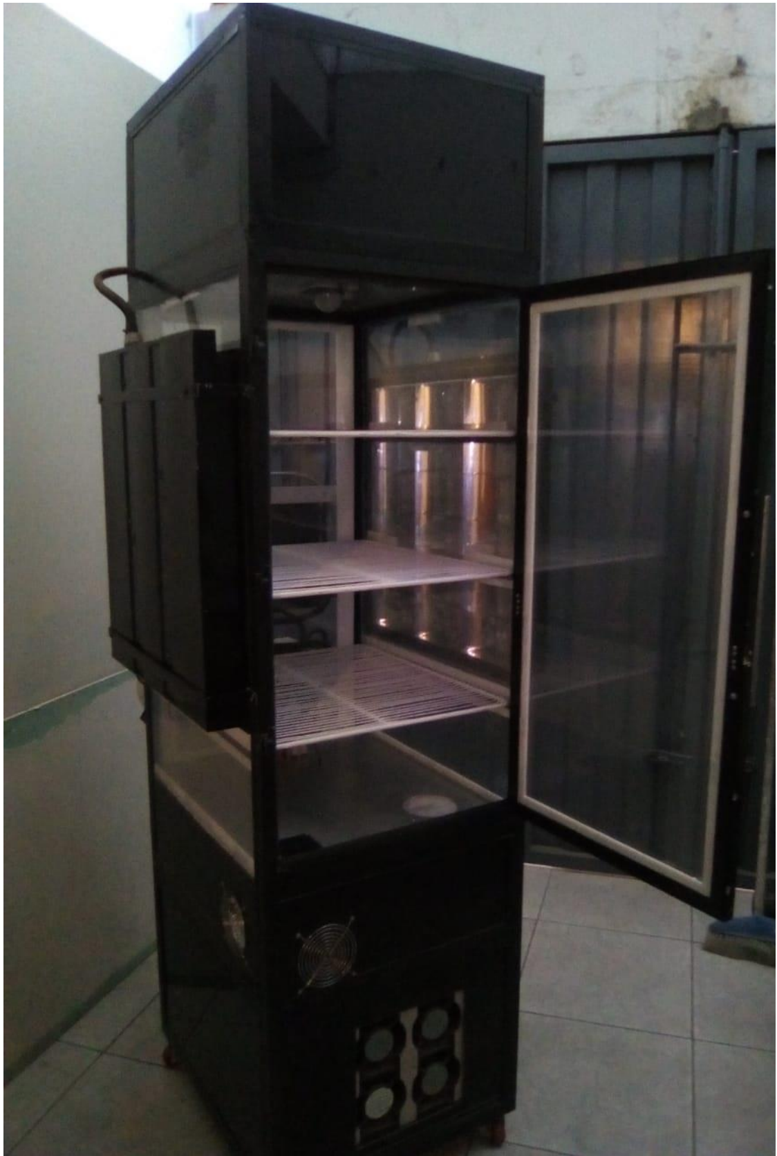
Figura 36: Estructura del fitotrón
