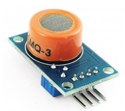
Figura N° 8: Sensor MQ3 Fuente: Naylampmechatronics (2018)
