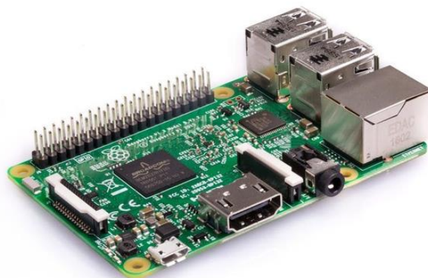
Figura N° 4: Dispositivo Raspberry Pi 3 Fuente: Raspberrypi.org(2015)
