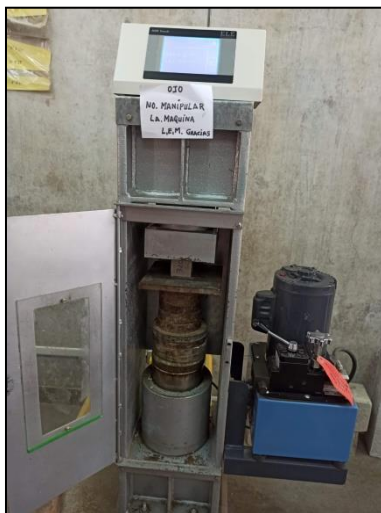
Figura 7: Equipo de compresión Fuente: Fotografía tomada en el laboratorio de la Universidad Ricardo Palma
