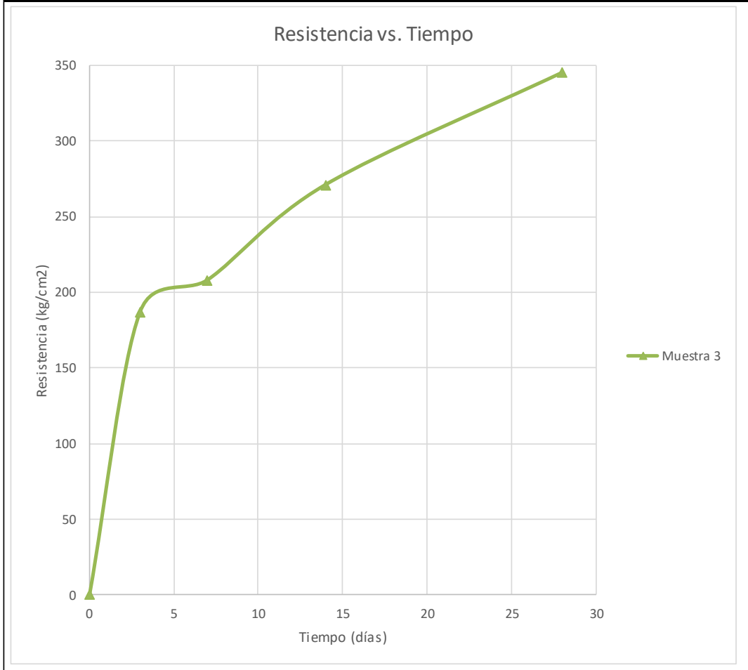
Figura 11: Repetición 3 del ensayo de resistencia a la compresión Fuente: Elaboración propia
