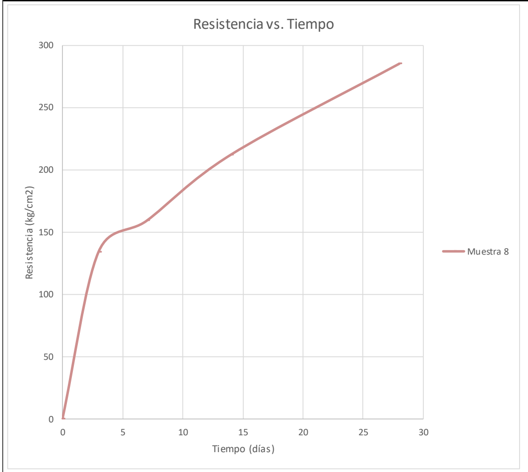
Figura 46: Repetición 8 del ensayo de resistencia a la compresión Fuente: Elaboración propia
