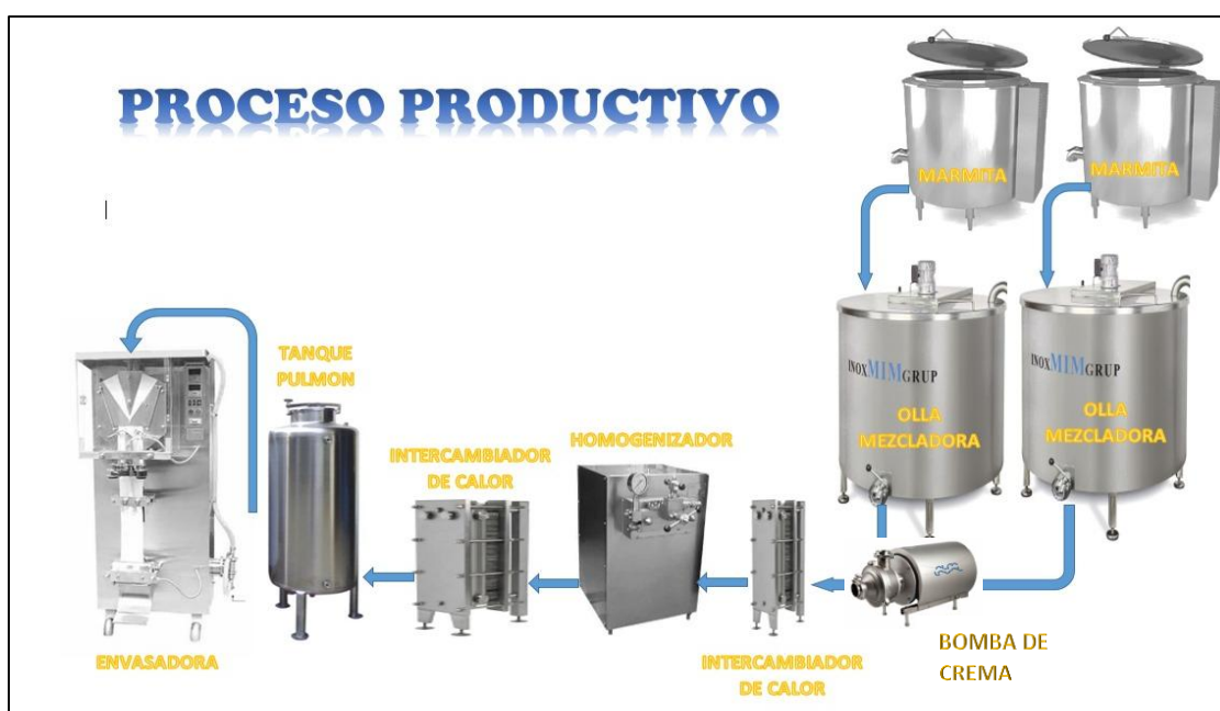
Figura N° 4: Proceso productivo de la línea de chantilly.
