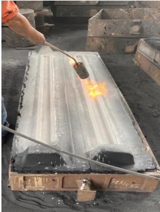
*Figura 19: Secado con lanzallamas*
