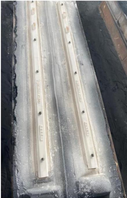
*Figura 22:* Alternativa de solución-Molde secado y pintado
