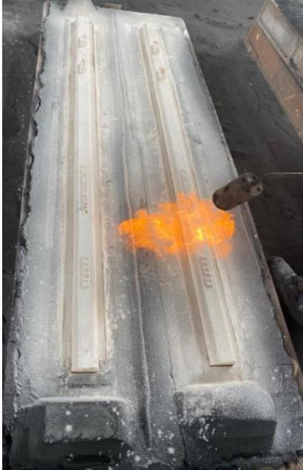
*Figura 21:* Segundo secado de molde
