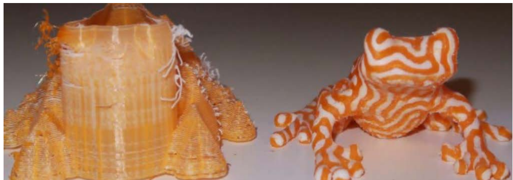
Figura 20. Método de purgas por carcaza externa para impresión FDM a doble material.
