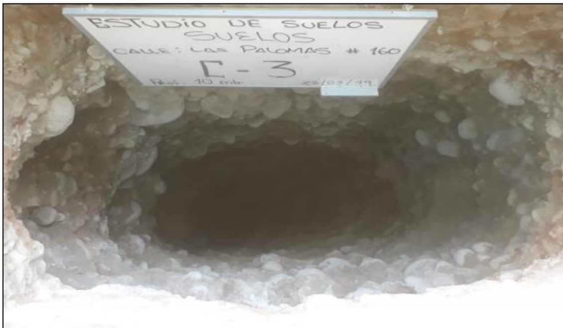
FOTO N° 14: Vista interior de la calicata C-3 donde se muestra el perfil estratigráfico del subsuelo. Se alcanzó una profundidad de exploración de 10.00m. No se encontró la presencia de nivel freático a dicha profundidad.
