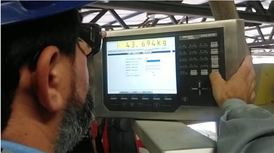
Figura 46: Calibración de la balanza
